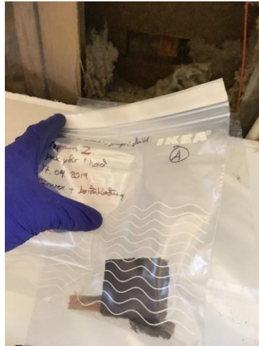
MYND 19: Sýni A2 –Yngri deild, þak 1.hæð, suðvesturálma, tjörutex og borðaklæðning.
