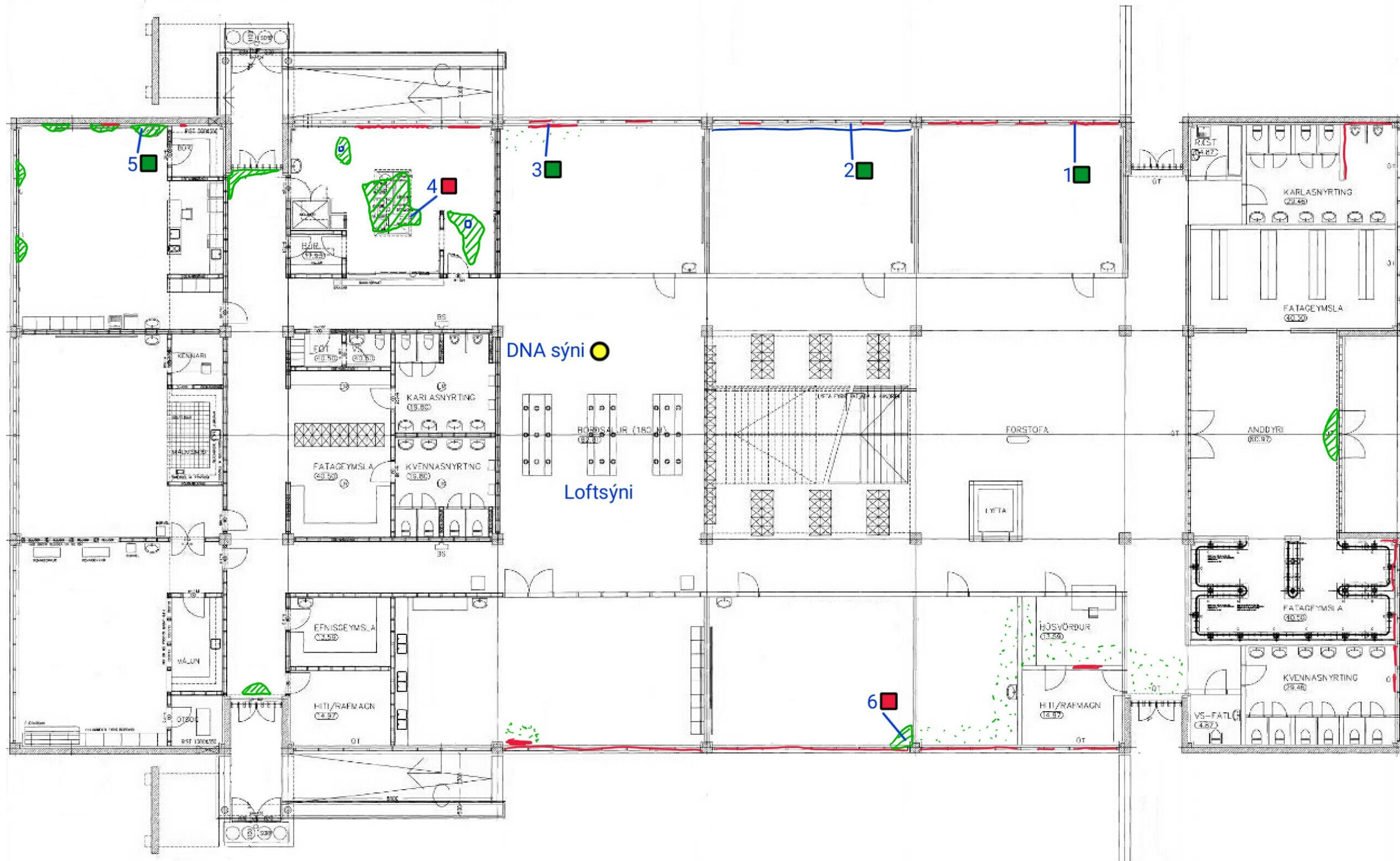
MYND 4: Eldri deild - grunnmynd 1.hæðar – rakaummerki og sýnatökustaðir merktir inn á teikningu.
