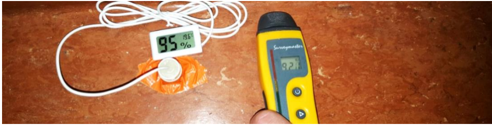
MYND 51: Dæmi um samanburð á hlutfallsrakamæli og snertirakamæli.
