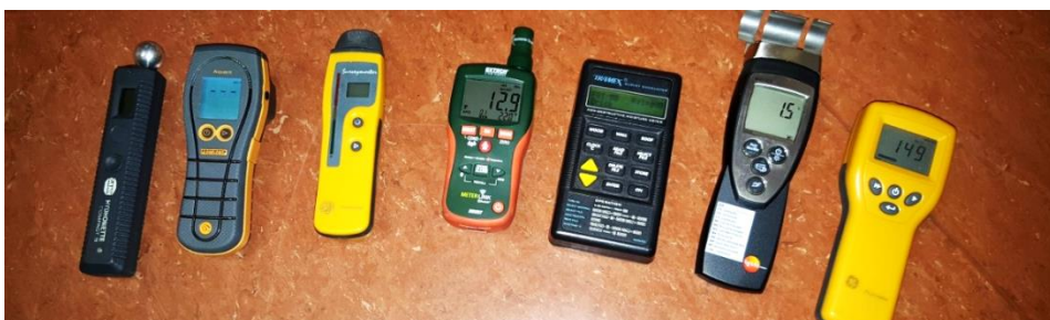
MYND 50: Dæmi um (non-invasive) eða snertirakamæla sem notaðir eru.
